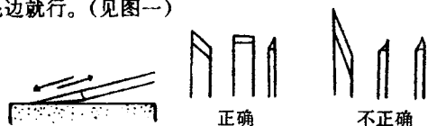
（图一）平刀和斜刀的磨法
